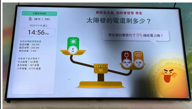
學校於穿堂設置 EMS 電力監控系統大電視，讓全校師生可以隨時知道每日用電量，亦可檢視是否過度浪費電
